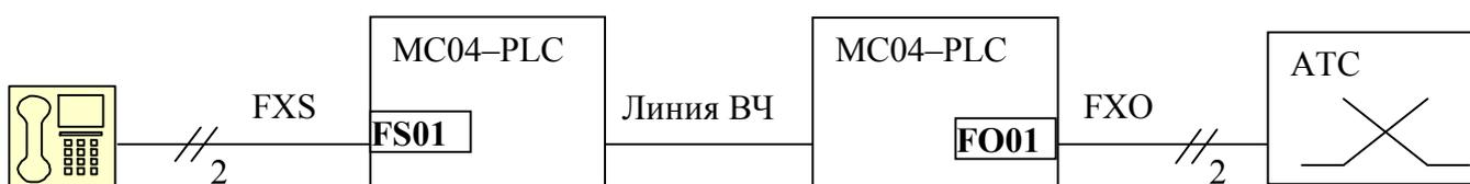
ТЧ канал аппаратуры помещается в разрыв 2-х проводного шлейфа между телефоном и абонентским комплектом АТС. Поддерживаются как тональный DTMF, так и импульсный набор номера. Занятие линии, вызывной сигнал, импульсный набор номера передаются на другую сторону вне полосы ТЧ в ЦП по ОКС.
