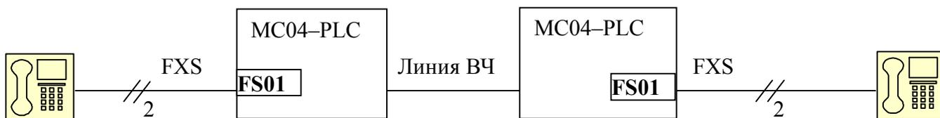
Обеспечивается прямое соединение между двумя телефонными аппаратами. При снятии трубки на телефонном аппарате одной стороны телефон на другом конце будет прерывисто звонить: 1 с – звонок, 4 с – пауза. Пока трубка на другом конце не снята, на поднятый телефон проходит акустический сигнал контроля посылки вызова (**КПВ**). При отсутствии связи между полуккомплектами выдается сигнал **Занято**.
