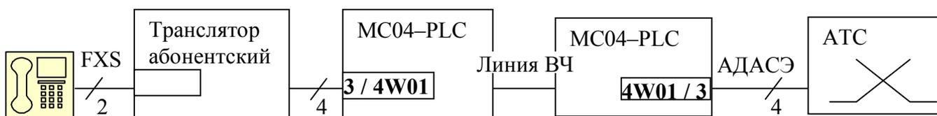
Абонент соединяется с АТС через 4-х проводный ТЧ канал, организованный с помощью модулей 4W01, аналоговый режим, порт 3 платы МП02. Подключение 2-х проводного телефона к 4-х проводному каналу обеспечивается абонентским транслятором, например типа АОТ12-ДК, который абонентскую сигнализацию FXS преобразует в сигнализацию АДАСЭ. Сигналы АДАСЭ – частотные сигнальные посылки 1200/1600 Гц – передаются без обработки прозрачно внутри полосы по ТЧ каналу.
